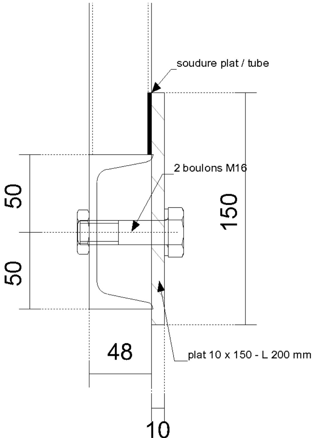
> efforts à reprendre : boulon en traction  $T = 1\,060$  daN dû au moment d'(encastrement + 67.5 daN dû à la poussée soit traction totale = 1 128 daN
